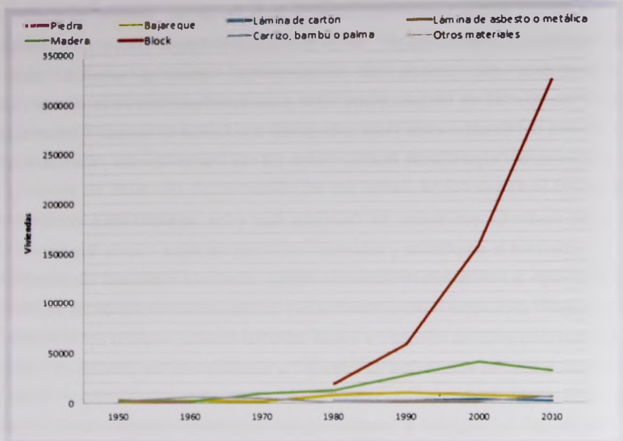
Gráfica 2.1. Principales materiales constructivos utilizados en muros en las viviendas de Q. Roo, México. Fuente: Elaboración propia con datos de INEGI.
