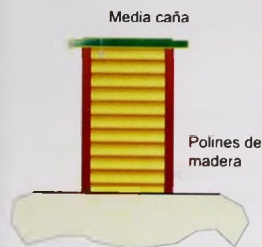
Imagen 4.14. Media caña de madera con aparejo horizontal. Fuente: Elaboración propia.
